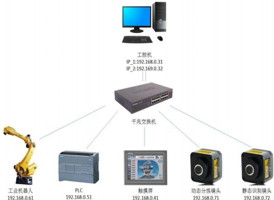
图 2-1 相机和编程计算机的连接示意图
